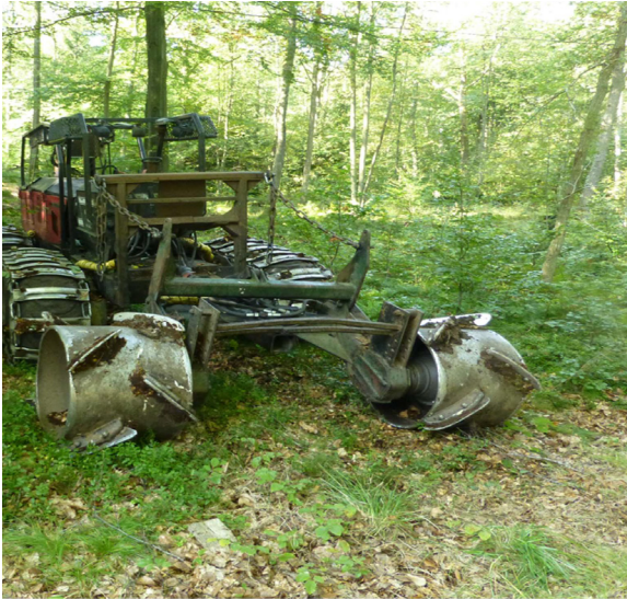
Exempel på radiostyrd inversal fläckmarkberedare
