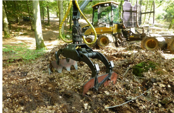
Skotare med specialbyggd grip för markberedning i bokskog.
