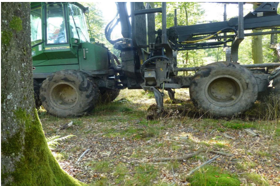
Fläckmarkberedare monterad i midjan på skotare.
